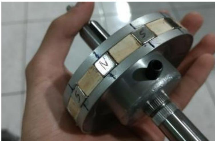
Com o segundo induzido permanente devidamente montado, foi realizado o segundo ensaio em laboratório, seguindo a mesma metodologia do primeiro ensaio.
