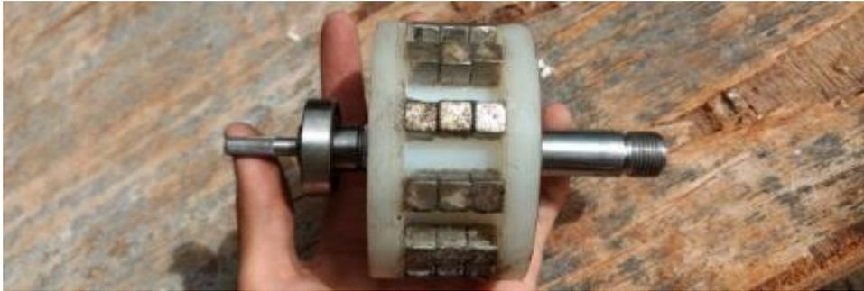
Os ímãs foram fixados na trincheira utilizando cola instantânea, formando 12 polos alternados, cada polo era formado por três ímãs, totalizando 36 ímãs.
