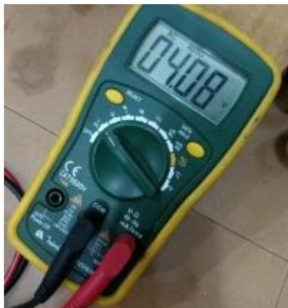
Com os alternadores sem carga, acoplados à fresadora, variou-se a rotação de 100 em 100 rpm, até 2000 rpm. A leitura da tensão gerada foi realizada em corrente contínua, após passar pela placa retificadora (Figura 9).
