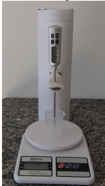
Figura 1 - Conjunto experimental utilizado para fixação do termômetro e determinação da massa de água.
