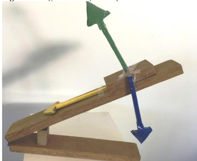
Figura 8 - Diagrama de forças num plano inclinado com atrito
