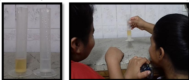
Imagens 1 e 2 – Experimento de extração e medição do teor de álcool na gasolina.
