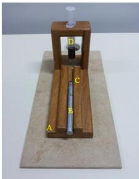
**Figura 1.** Estrutura do Projetor Gota D'Água: A – Base do projetor; B – feixe luminoso (laser); C – Ajuste de foco; D – Seringa com amostra posicionada
