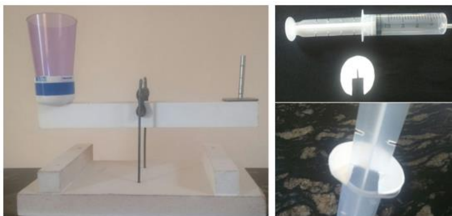
Figura 1 – A Figura à esquerda apresenta a balança adaptada. A Figura da direita expõe a seringa com a haste para fixação no êmbolo e medição de volumes.
