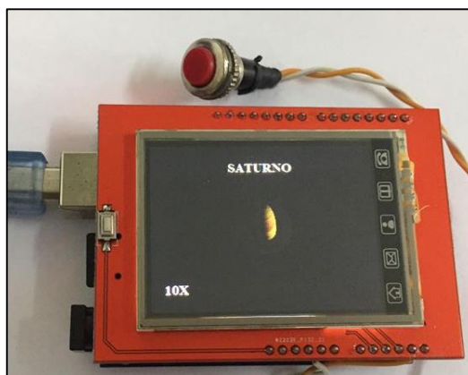
Figura 1 – Arduino UNO com display LCD mostrando a imagem de Saturno, com ampliação aparente de 10x.
