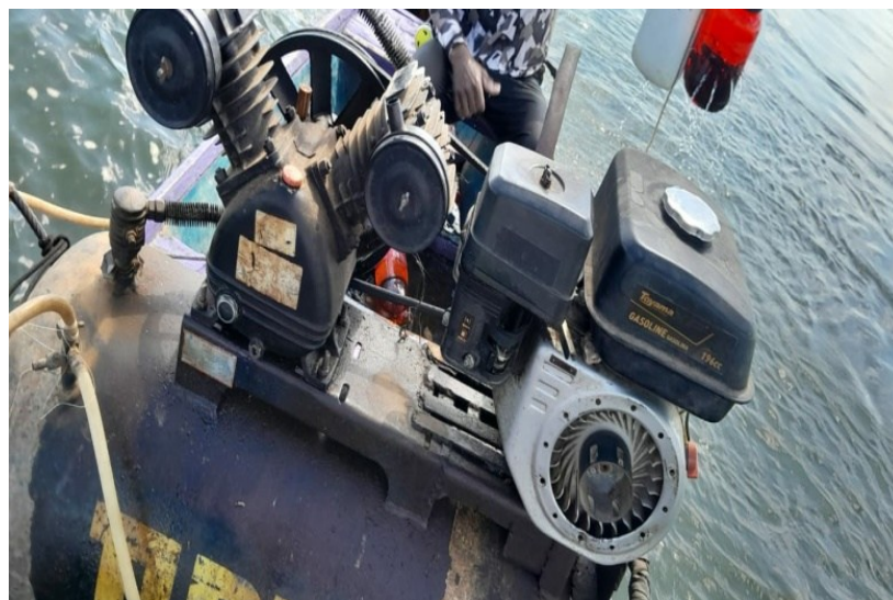
Figura 3 – Compressor de ar
