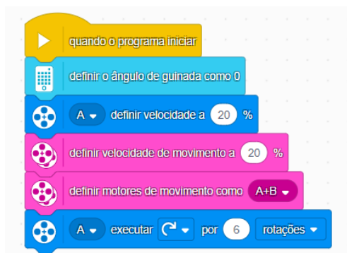
Figura 3- Programação para o robô desenhar uma circunferência
