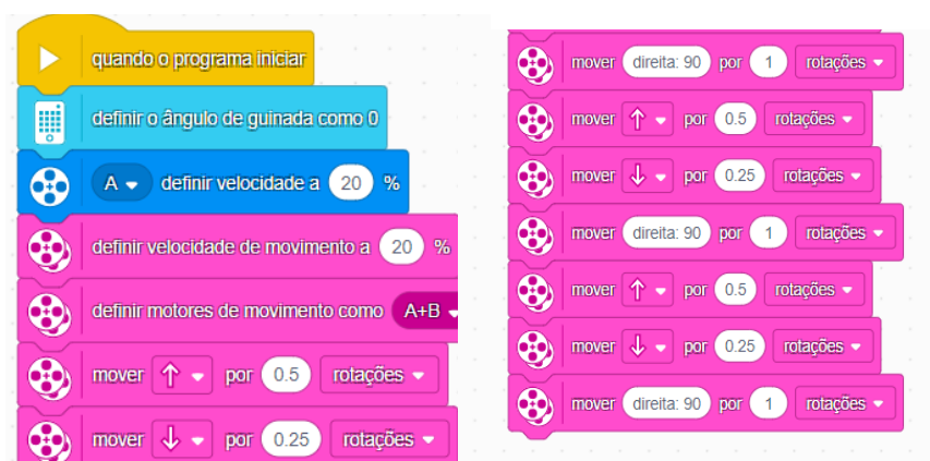
Figura 5 - Programação para o robô desenhar um triângulo retângulo
