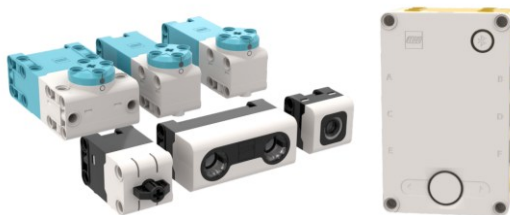
Figura 01 - Motores, sensores e hab do kit Lego Spike Prime
