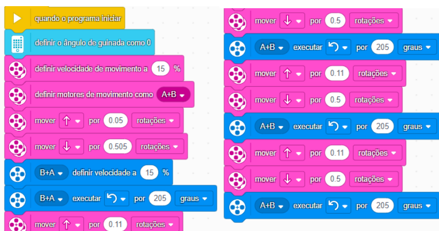
Figura 2- Programação para o robô desenhar o quadrado
