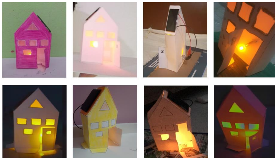
Figura 2. Maquetes da casa elétrica montadas pelos alunos; lâmpada LED, bateria e placa solar. Sequência didática
